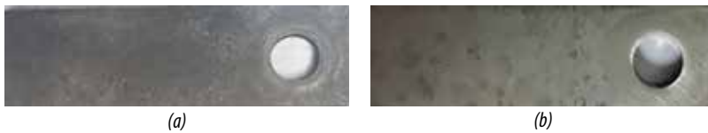
Hình 8. Hình ảnh mẫu bị ăn mòn trong môi trường trong pha khí điều kiện tĩnh (a) và điều kiện động (b).
