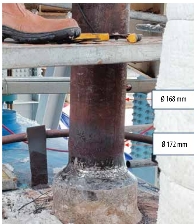
Hình 6. Ống hơi bị phồng sau khi sửa lần 1.
