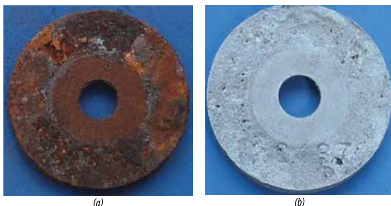
Hình 6. Hình ảnh mẫu bị ăn mòn sau 21 tháng đặt trong đường ống thực tế vị trí đáy ống: (a) trước khi tẩy gỉ, (b) sau khi tẩy gỉ.
